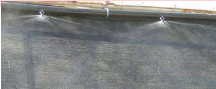
Rociador Modular de medio círculo 100 l/h montado cada 1,0 m
